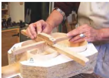
STEP 30. Checking the curvature
